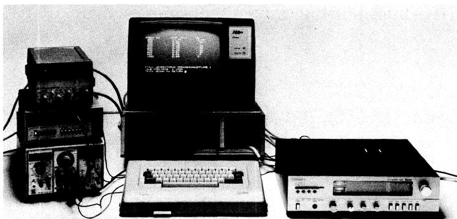
Bild 69a. ABC80 som IEC-dator. Till IEC-bussen är de båda övre instrumenten inkopplade. Funktionsgeneratoren längst ner i mitten styrs från en DAC. Mätning görs av frekvensgången på receiveern till höger bilden.
